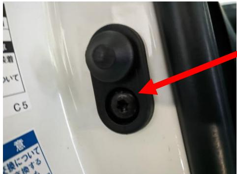
不具合設定があった運転席カーテシスイッチの取り付けボルトは、特殊なボルトのため本来公表された工具では取外すことができないが、プラスドライバーで取り外すことができるよう、ボルトが交換されていた。
